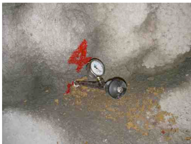
Figura 9 - Tensiômetro instalado na frente de escavação da calota para medida de sucção.
