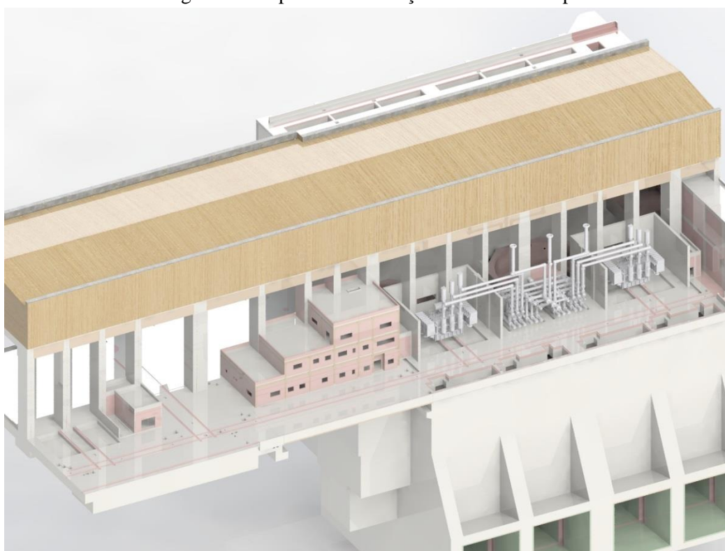
Figura 4. Vista 3D – Aplicação Subestação GIS na Casa de Força da UHE Sinop
